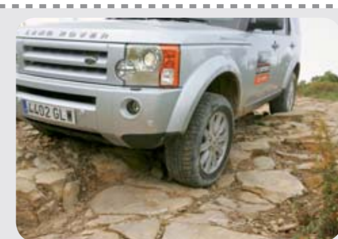
Subidas como ésta sobre losas y en pendiente lateral pueden afrontarse sin problemas, siempre que estén secas. Basta con subir en marchas cortas y a una velocidad baja pero constante.
