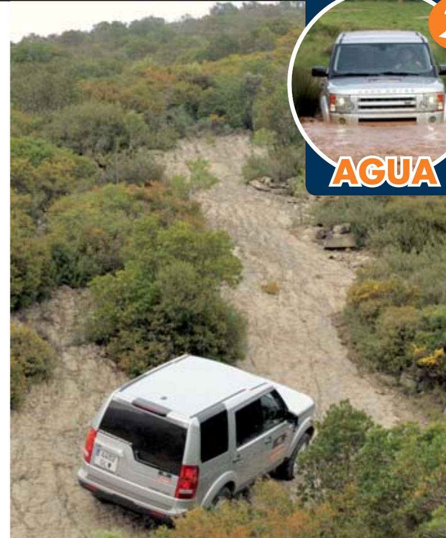
Subidas como ésta sobre losas y en pendiente lateral pueden afrontarse sin problemas, siempre que estén secas. Basta con subir en marchas cortas y a una velocidad baja pero constante.
